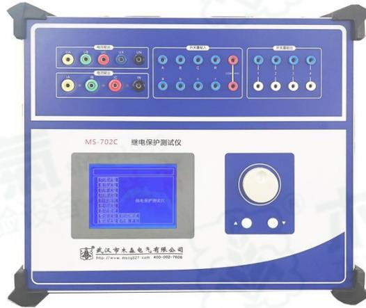
标准的4相电压3相电流输出 具有4相电压3相电流输出，可方便地进行各种组合输出进行各种类型保护试验。每相电压可输出120V，电流三并可输出120A，第4相电压 $U_x$ 为多功能电压项，可设为4种3U<sub>0</sub>或检同期电压，或任意某一电压值的情况输出。
