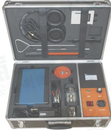
产品配合路径探测接收机（即下节详述的“声磁数显同步定点仪”）能可靠地探测各类地埋电力线缆、金属管道的埋设路径及埋设深度。
